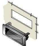
3. 从拉手和门板后面装上拉手罩,并用两个螺钉(提供)固定。
