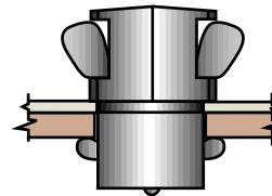
挤压手柄，松开搭勾，拉起门板开启。锁定时，只需将用劲关上门板。
